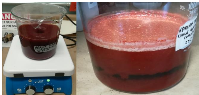
Figura 3.4. Agitación (izquierda) y reposo (derecha) de chile guajillo mexicano durante la extracción de minerales por el método de densidades
