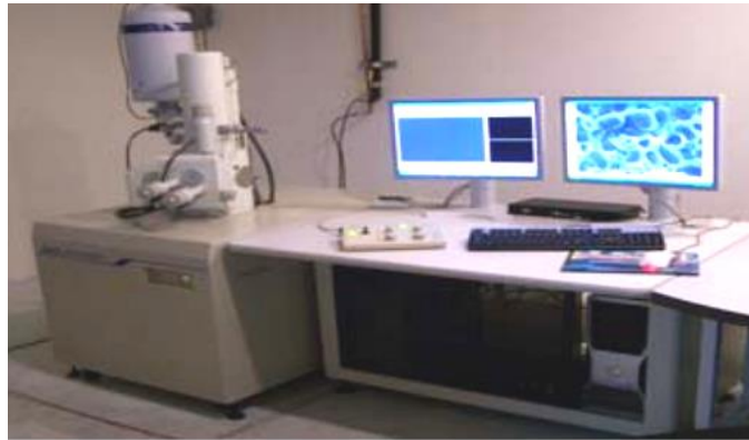
Figura 3.6. Microscopio electrónico de barrido JEOL modelo JSM-6390 LV ubicado en CICATA-Legaria (Adaptada de: CICATA, 2020)
