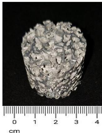
**Figura 34.** Probeta para ensayos de compresión según la norma ASTM E89.
