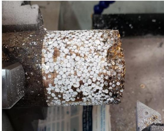
*Figura 70. Proceso de torneado de espuma metálica de CuAlBe.*
