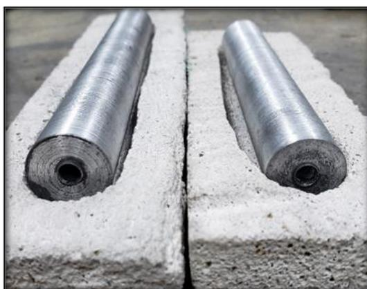
**Figura 23.** Aleación Al-5Ti con nano-carbono situado en el centro de la probeta antes del tratamiento térmico de difusión.
