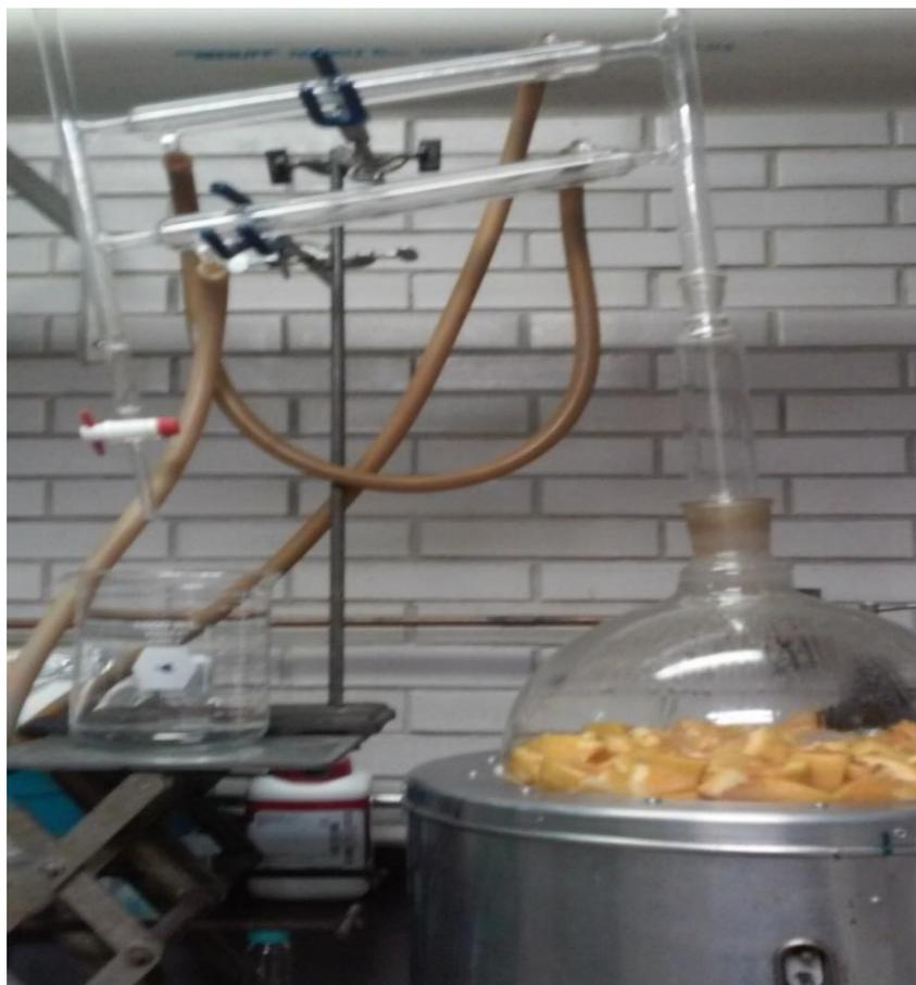
**Figura 10.** Proceso de extracción del aceite de toronja. Método arrastre de vapor.
