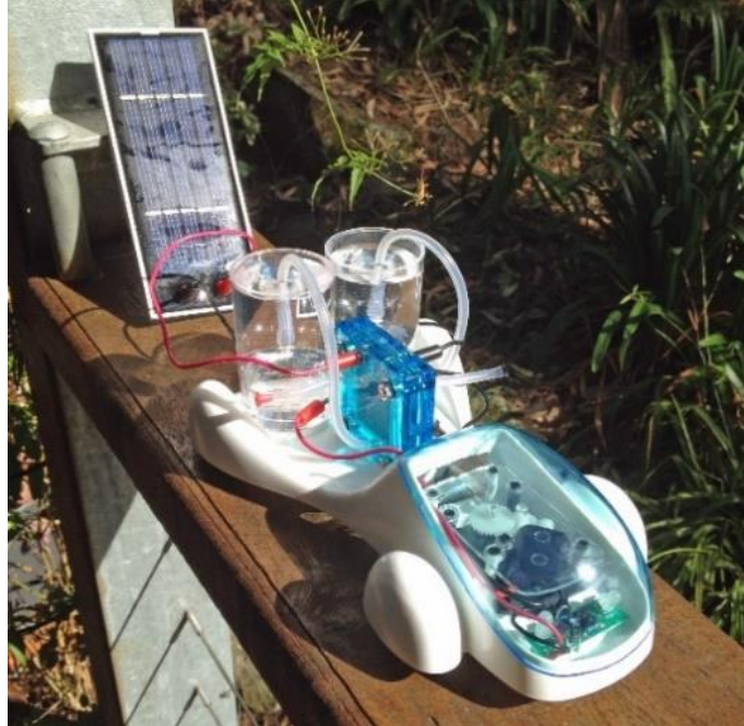
Fotografía 6. Carro de Celda de Combustible de Hidrógeno Cargando (Ridgway, 2013)
