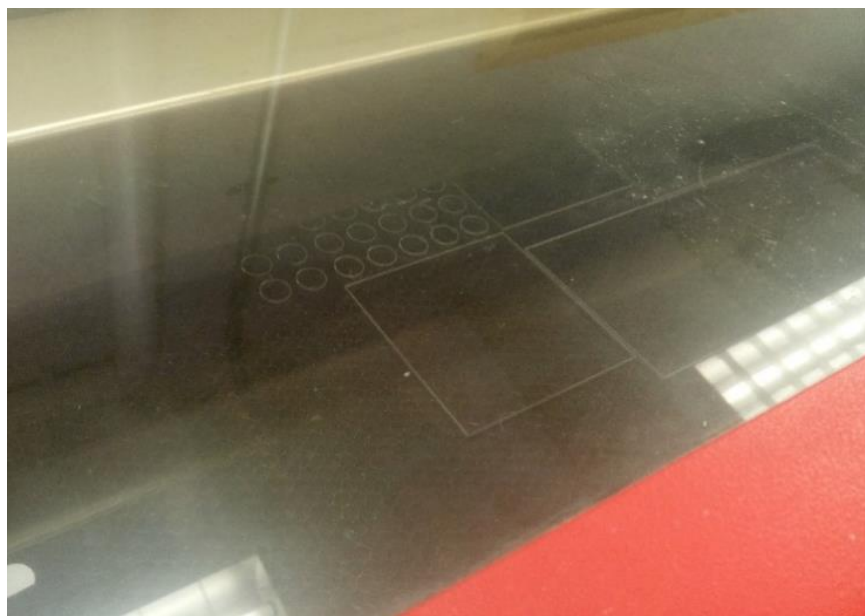
Fotografía 7. Corte de acrílico a láser en Cortadora Laser VERSA LASER VLS2.30
