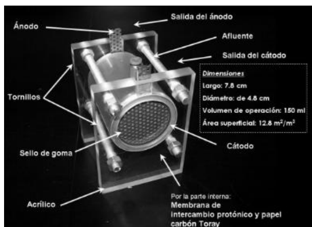
Imagen 8. Configuración de la Celda de Combustible Microbiana (Carmona, 2008)
