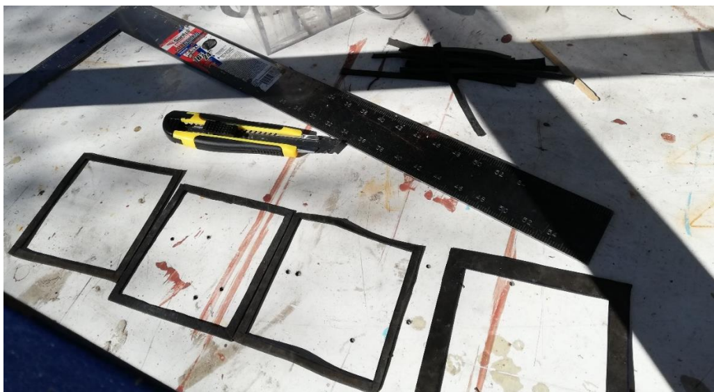
Fotografía 12. Corte de empaques para Celda de Combustible Microbiana de flujo continuo
