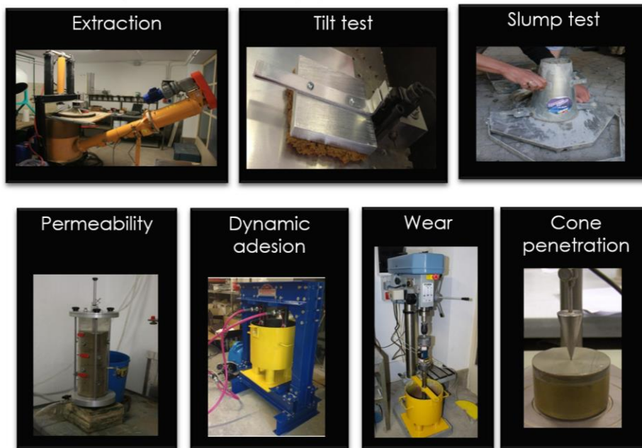
Figura 15 Pruebas de laboratorio en suelos. Fuente: D. Peila.
