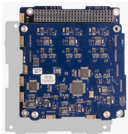
Figura 23. EPS comercial para nanosatélite, imagen obtenida de [33]
