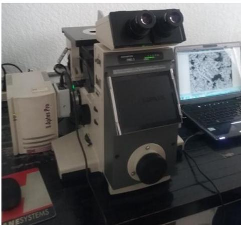
Figura 45. Microscopio con cámara instalada.
