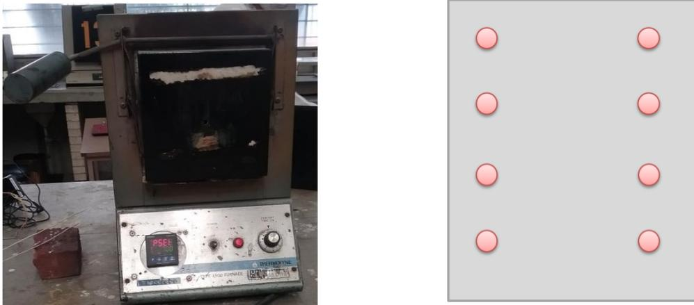
Figura 48. a) Horno Mufla empelado para los TH; b) Acomodo de piezas dentro de la mufla.
