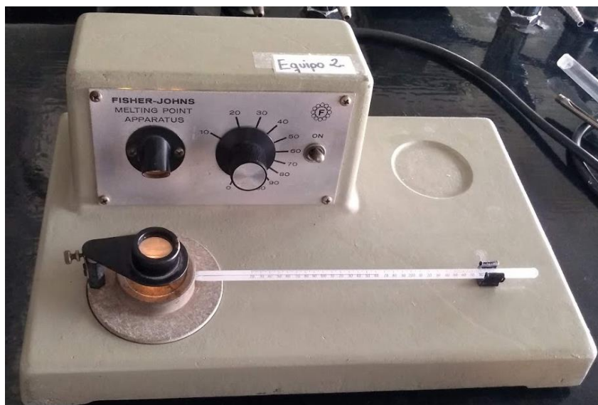
Figura 27. Equipo Fisher-Johns. Fotografía tomada en el laboratorio de Química Experimental Aplicada L-103.
