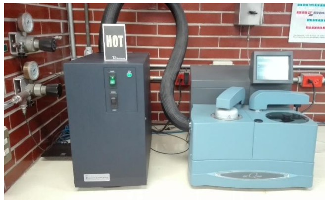
Figura 16. Calorímetro Diferencial de Barrido Q2000, marca TA Instruments.
