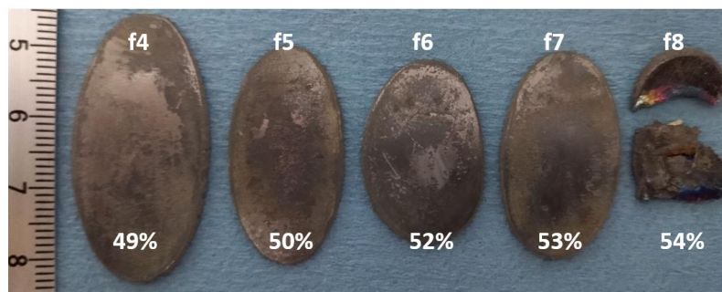
Figura 39. Láminas de fundiciones f4 a f8 (49% a 54% at. Ni), vista superior.
