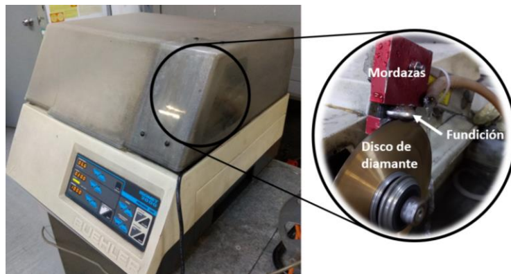
Figura 24. Cortadora modelo ISOMET 2000 de la marca BUEHLER. Disco de diamante marca LECO, modelo 801-136.
