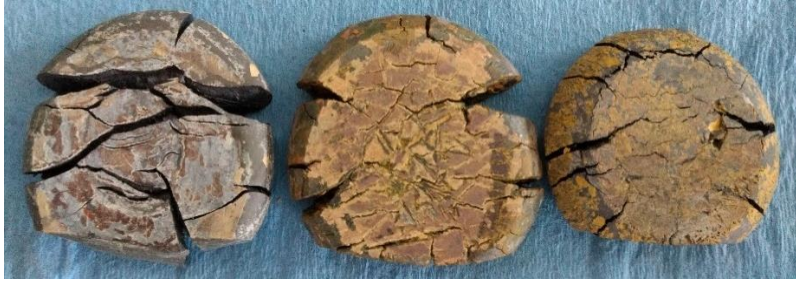
Figura 37. Aspecto de f1, f2 y f3 después de la primera laminación.
