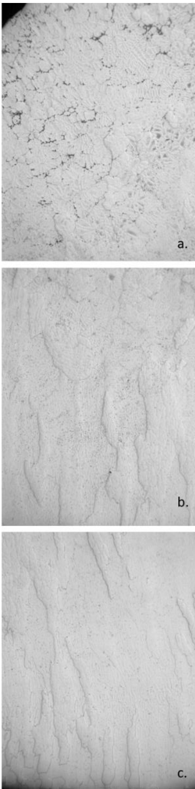
Figura 41. Metalografía del corte transversal de un botón salido de fundición.
