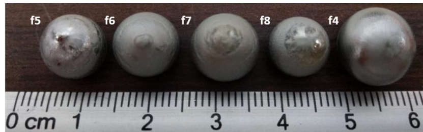
Figura 38. Fundiciones f4 a f8 (49% a 54% at. Ni), vista superior.
