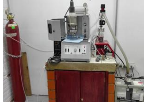
Figura 19. Horno de Arco Eléctrico (HAE) modelo MAM1, marca Edmund Bühler GmbH.
