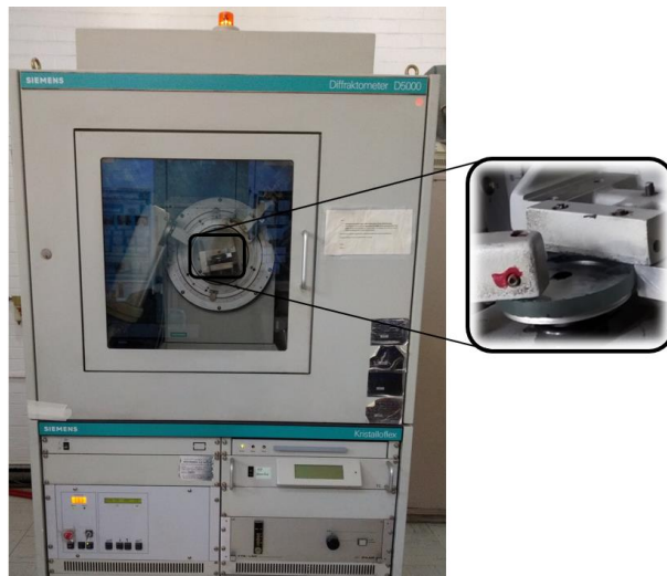
Figura 26. Difractómetro de Rayos X de la marca SIEMENS modelo D5000.
