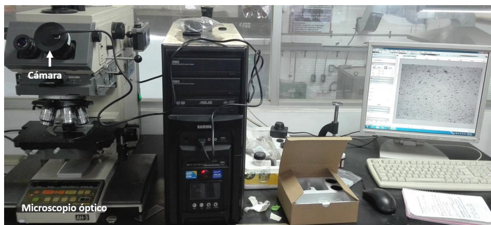
Figura 15. Microscopio óptico de la marca OLYMPUS, modelo VANOX AHMT3; y cámara digital para microscopio de la marca OMAX, modelo A35100U.
