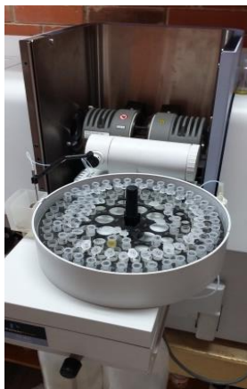
Figura 8. Espectrofotómetro de absorción atómica (EAA) con sistema de corrección por efecto Zeeman acoplado con horno de grafito (AAnalyst 800, Perkin-Elmer).
