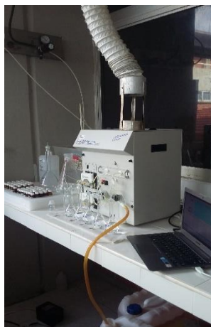
Figura 9. Espectrofotómetro de fluorescencia atómica PSAnalytical (Millennium Excalibur).
