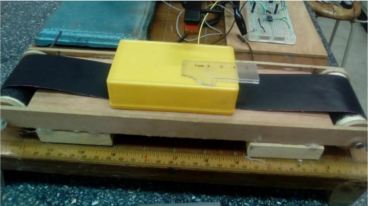
*Figura 4.7 Colocación de la segunda pieza sobre nuestro dispositivo auxiliar de arrastre para la aguja.*
