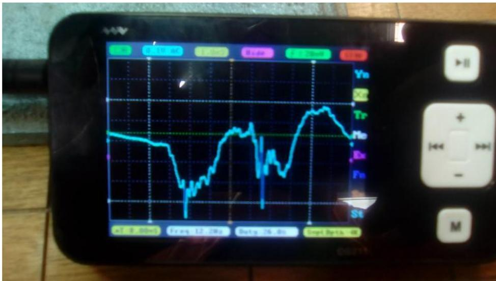
*Figura 4.8 Primera prueba de rugosidad de la pieza 2*
