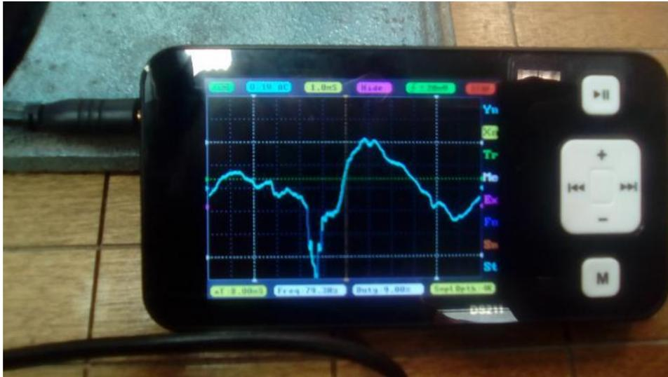
*Figura 4.9 Segunda prueba de rugosidad de la pieza 2*
