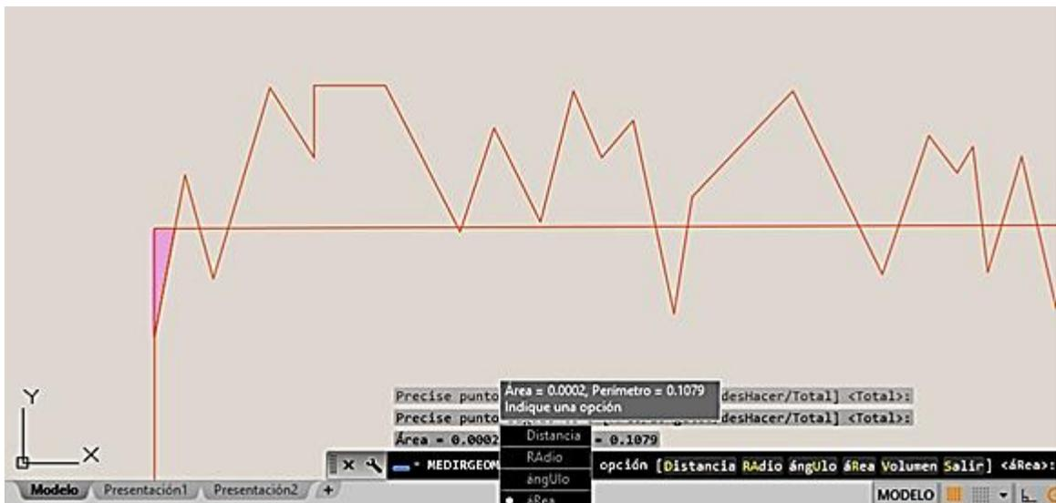
**Figura 3.15 Aplicación del comando measure para obtener las áreas.**
