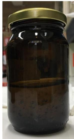
**Figura 27.** Hidrogel ELT-PVP obtenido por irradiación gamma con  $^{60}\text{Co}$ .
