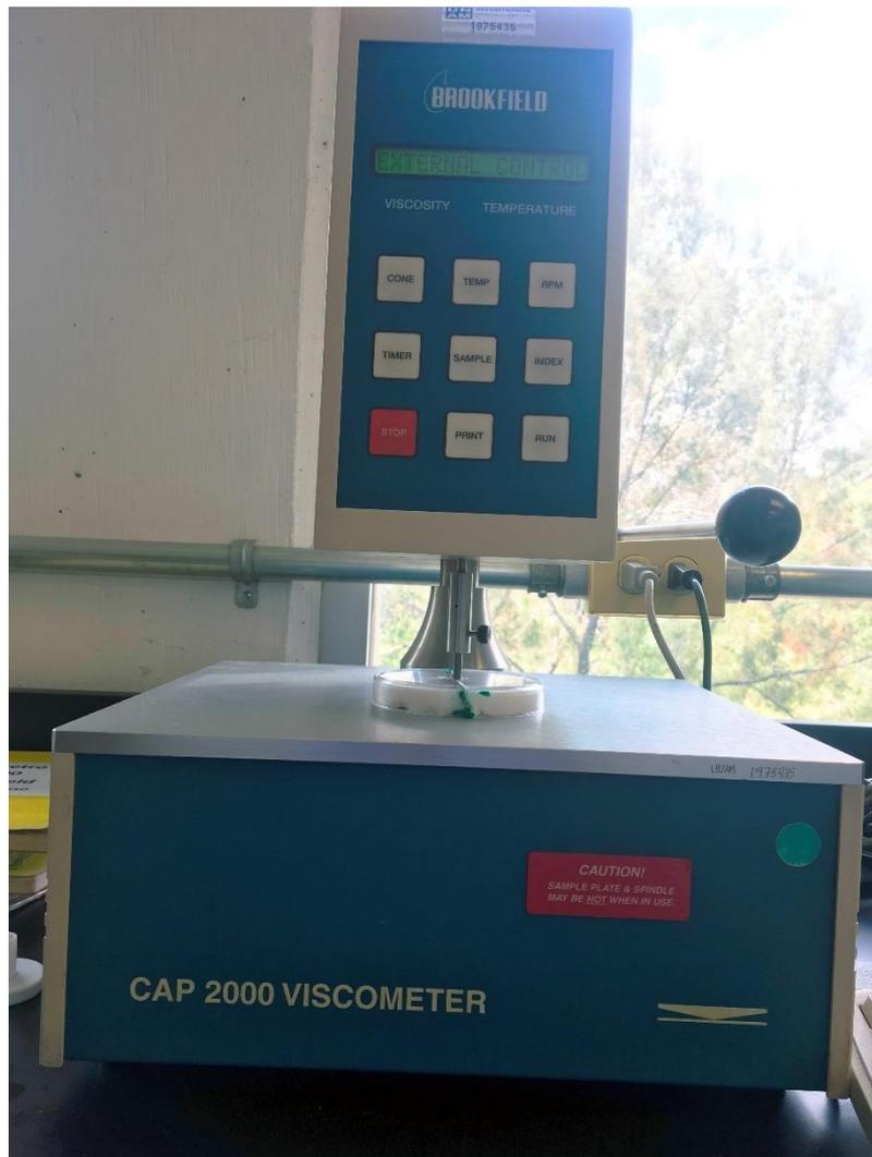
Figura 22. Viscosímetro Brookfield CAP 2000 con control de humedad.
