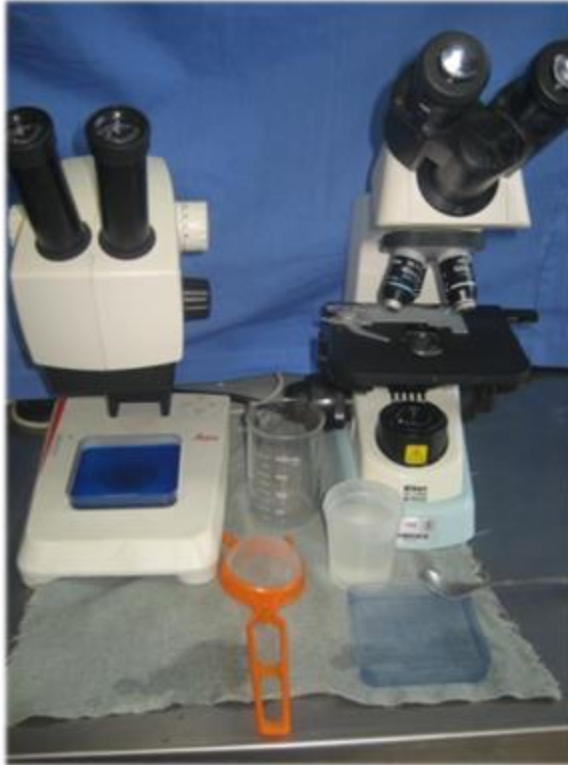
Figura 1. Material necesario para realizar la técnica de sedimentación. Fuente: Miguel Ángel Martínez Castillo.
