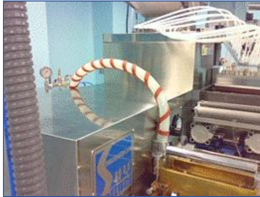
Figura 28. Manguera de alimentación de gelatina hacia spreader box “caja de gelatina”. Farmacéutica dedicada a la producción de medicamentos y suplementos alimenticios.
