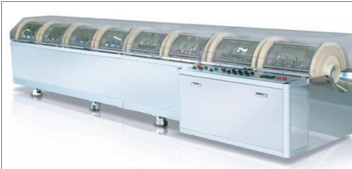
Figura 35. Tren de Tumblings de secado o “Train tumbling”. (Kingdom, 2019)
