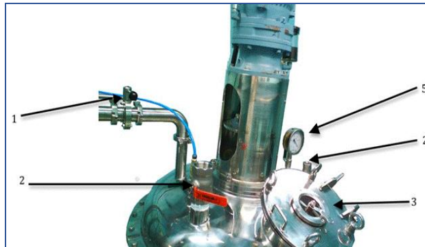
Figura 16. Vista superior del tanque de fabricación de gelatina. 1. Válvula de vacío. 2. Válvula para liberar el vacío. 3. Válvula de carga de productos líquidos. 4. Escotilla de carga. 5. Manómetro. Farmacéutica dedicada a la producción de medicamentos y suplementos alimenticios.
