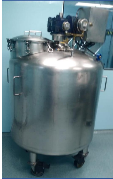
Figura 8. Tanque de almacenamiento, Farmacéutica dedicada a la producción de medicamentos y Capsulas de Gelatina Blanda.
