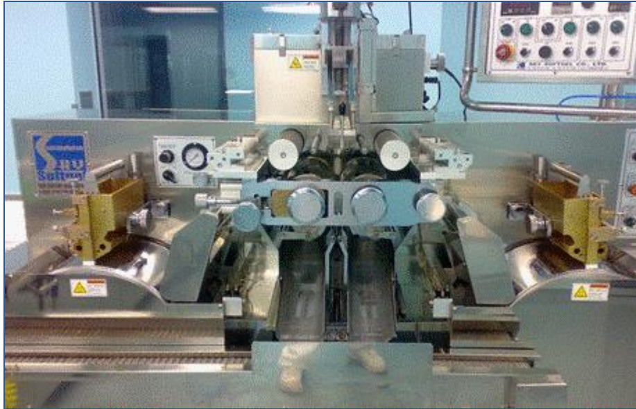
Figura 24 Encapsuladora armada con engrane de cambio, formato y segmento para iniciar encapsulado. Farmacéutica dedicada a la producción de medicamentos y suplementos alimenticios.
