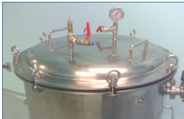
Figura 19. Vista superior del tanque de servicio con chaqueta de calentamiento para descarga de gelatina. Farmacéutica dedicada a la producción de medicamentos y suplementos alimenticios.
