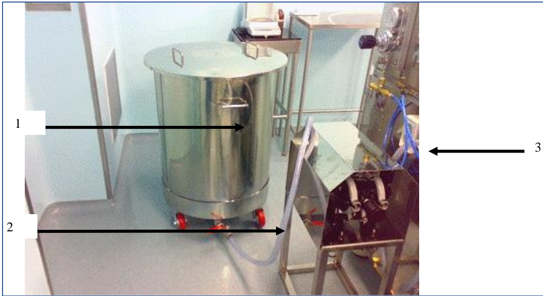
Figura 26. Línea de alimentación de contenido. 1. Tanque de fabricación de contenido. 2. Válvula. 3. Bomba peristáltica. Farmacéutica dedicada a la producción de medicamentos y suplementos alimenticios. Farmacéutica dedicada a la producción de medicamentos y suplementos alimenticios
