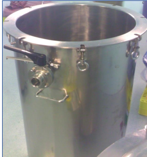
Figura 18. Tanque de servicio con chaqueta de calentamiento para descarga de gelatina. Farmacéutica dedicada a la producción de medicamentos y suplementos alimenticios.
