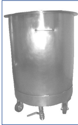
Figura 6. Tanque de servicio con chaqueta de enfriamiento, Farmacéutica dedicada a la producción de medicamentos y Capsulas de Gelatina Blanda.
