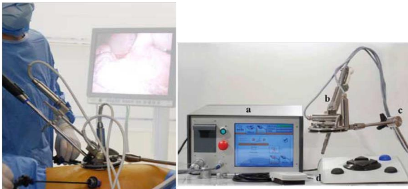
Figura 2.9 Izquierda: Robot ViKY posicionado en el cuerpo del paciente. Derecha: unidad de control de ViKY. (a) Consola, (b) robot sujetador de cámara, (c) pedal de seguridad para control de voz, (d) pedal sin control de voz.
