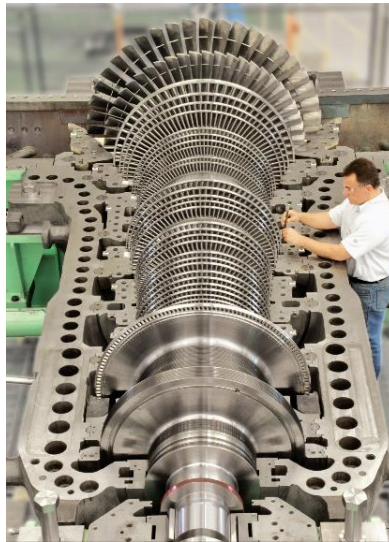
Figura 23. Turbina de vapor.
