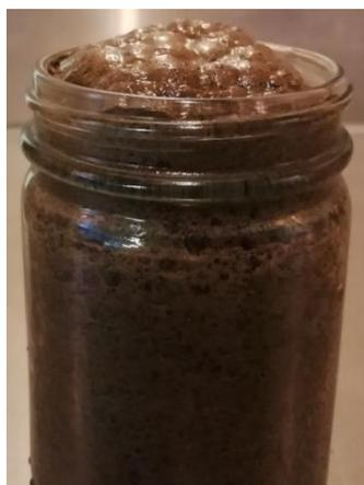
Figura 7. Reacción del  $\text{H}_2\text{O}_2$  con el suelo contaminado.
