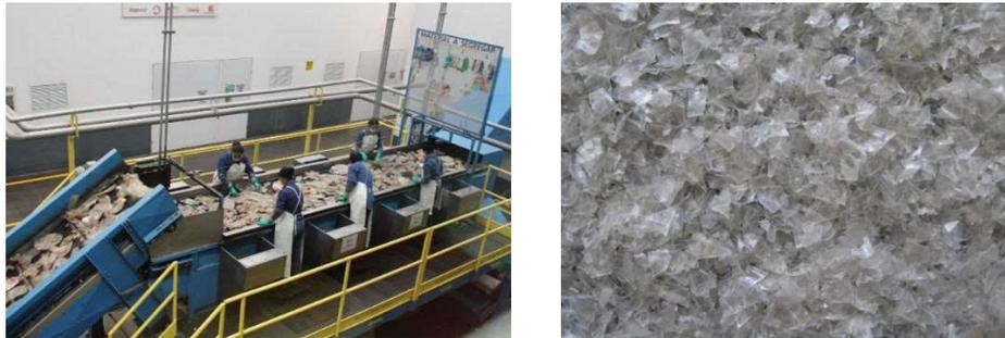
Figura 6.6: Proceso de clasificación por material y color hecho por empleados y hojuelas formadas después de la tritución del PET.
