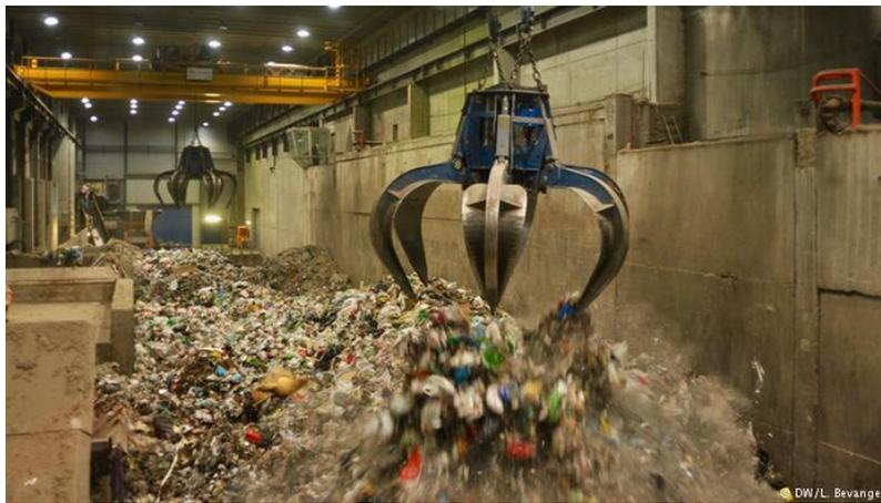
Figura 4.6: Maquinaria utilizada en el procesamiento de desechos plásticos en la planta de incineración de Klemetsrud en Oslo, Noruega.
