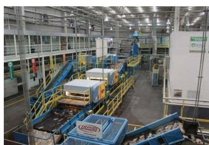
Figura 6.5: Los paquetes se rompen y las botellas pasan por un prelavado con sustancias químicas.
