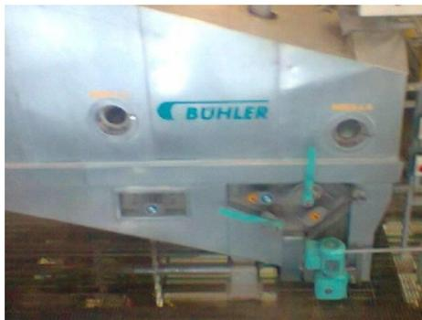
Figura 6.7: Maquinaria para secar y calentar las hojuelas de PET.
