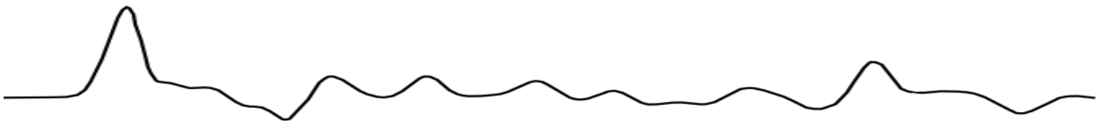
Figura 4.4. Componente vertical de la señal del sismo del 08/10/2017 a las 04:34:17 UTC registradas por las estaciones B8, 1028 y A1. Las señales se filtraron con un filtro pasa-bandas (2 Hz-8 Hz).
