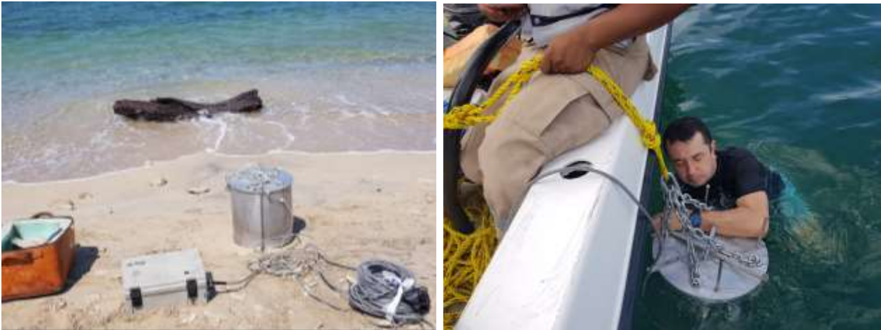
Figura 5.3. (Izquierda) muestreador Kinemetrics modelo K2, (Derecha) OBS diseñado para el experimento en la bahía de Zihuatanejo.
