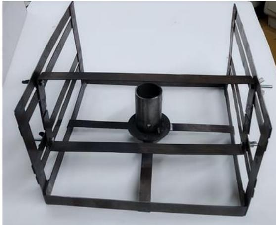
Figura 14. Soporte metálico de termopares y quemador.
