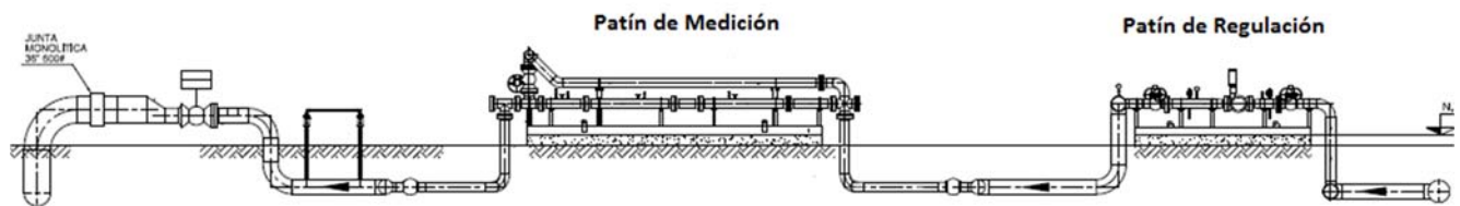
Figura 12. Estación de Medición Regulación y Control (EMRyC)
