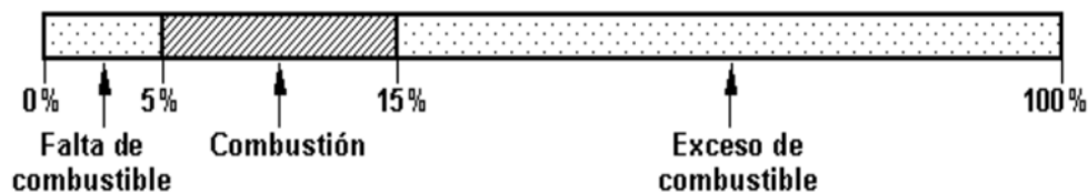
Figura 1. Límites de inflamabilidad en mezclas de gas metano más aire. (Robles & Ricardo, 2016)
