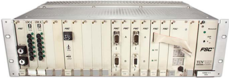
Figura 37. Ejemplo de 2a generación de sistemas de seguridad; FSC de Honeywell. ( Classic Automation LLC, 2018 )
