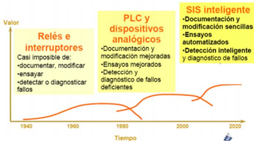
Figura 39. Evolución de los sistemas de seguridad. ( Emerson Process Management, 2018 )
