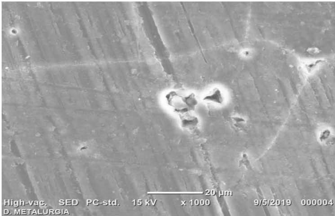
Figura 3.16 Micrografías de aluminio coloreado sin sellado al término de la prueba de ruido electroquímico
