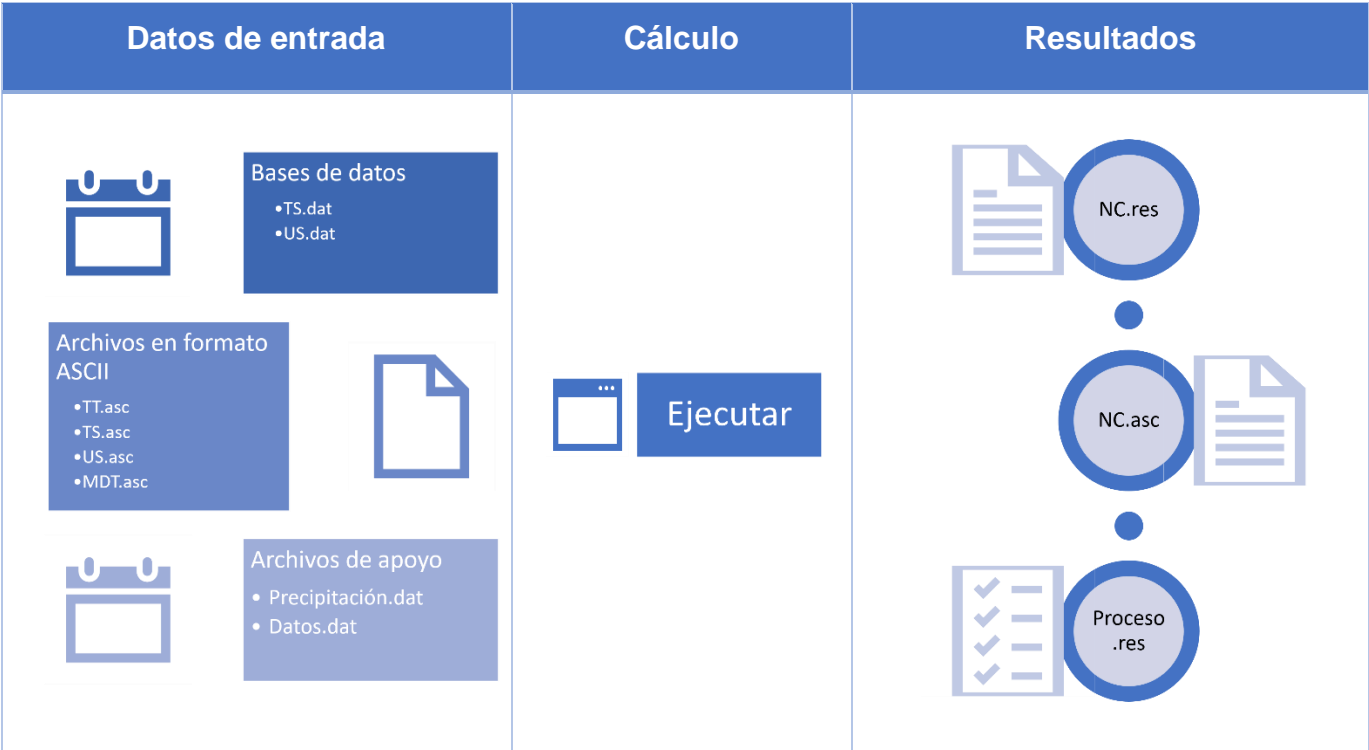
Figura 22 Esquema del proceso para calcular el número de curva.
