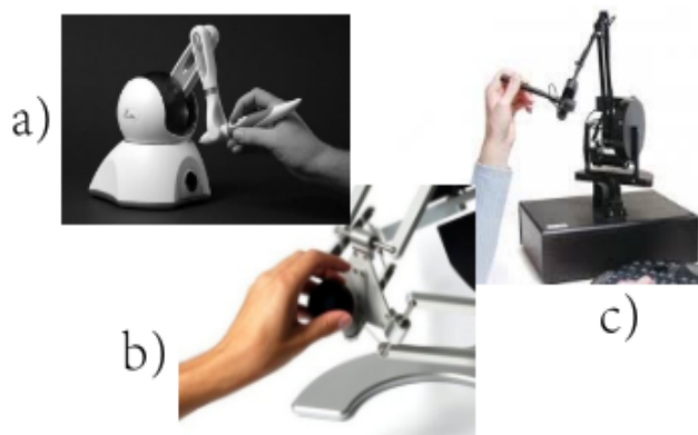
Figura 3.2: Efector final de diferentes dispositivos hápticos (a) Geomagic Touch , b) Omega.3 y c) Phantom Premium 1.5 .
