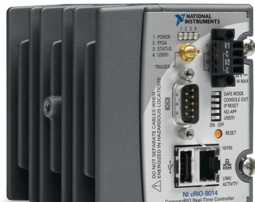
Figura 3.12: Controlador cRIO-9014 de la empresa National Instrument (imagen obtenida de la página oficial de NI).
