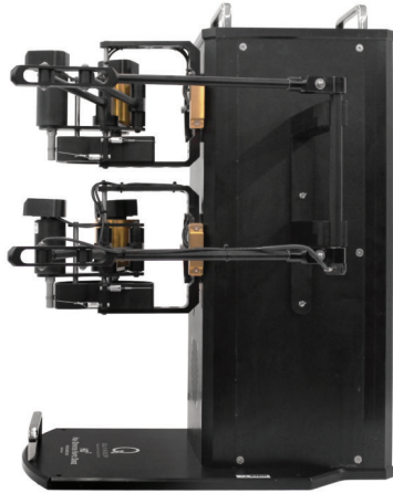
Figura 1.9: El dispositivo háptico HD2 High Definition Haptic Device diseñado y contruido por Quanser(imagen obtenida de la página oficial de la empresa Quanser).
