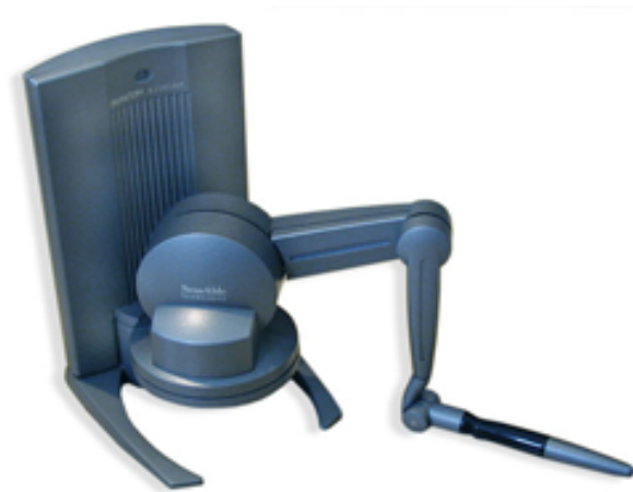
Figura 1.1: PHANTOM Desktop de SensAble Technologies . Se trata de un popular dispositivo háptico. La posición y la orientación de la pluma se rastrean a través de encoders en el brazo robótico. Tres grados de fuerza en la dirección x , y y z , se logran a través de motores que aplican pares en cada articulación (imagen obtenida del distribuidor 3D Systems ).
