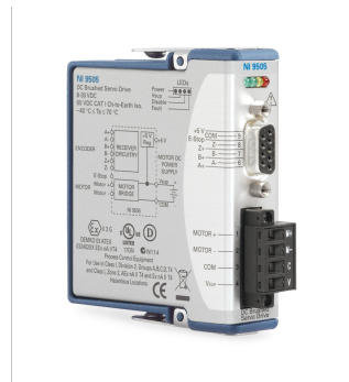
Figura 3.13: Módulo controlador de Servo motor DC de la serie C, con Escobillas y Puente H Completo (imagen obtenida de la página oficial de NI).
