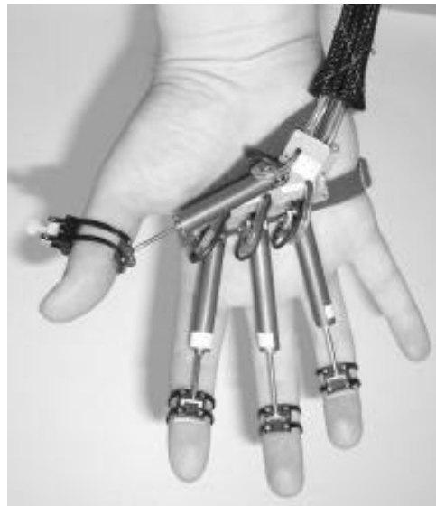
Figura 1.5: La Rutgers Master II—Nuevo diseño. Apariencia general del prototipo [14]
