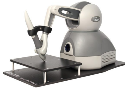
Figura 1.10: El dispositivo Omni Bundle de Quanser rediseñado a partir del robot Geomagic Touch de SenSable Technologies (imagen obtenida de la página oficial de la empresa Quanser).
