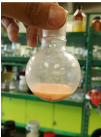
Figura 22. Mezcla de reacción catalizada por vinagre de alcohol de caña después de 20 minutos de irradiación de microondas.
