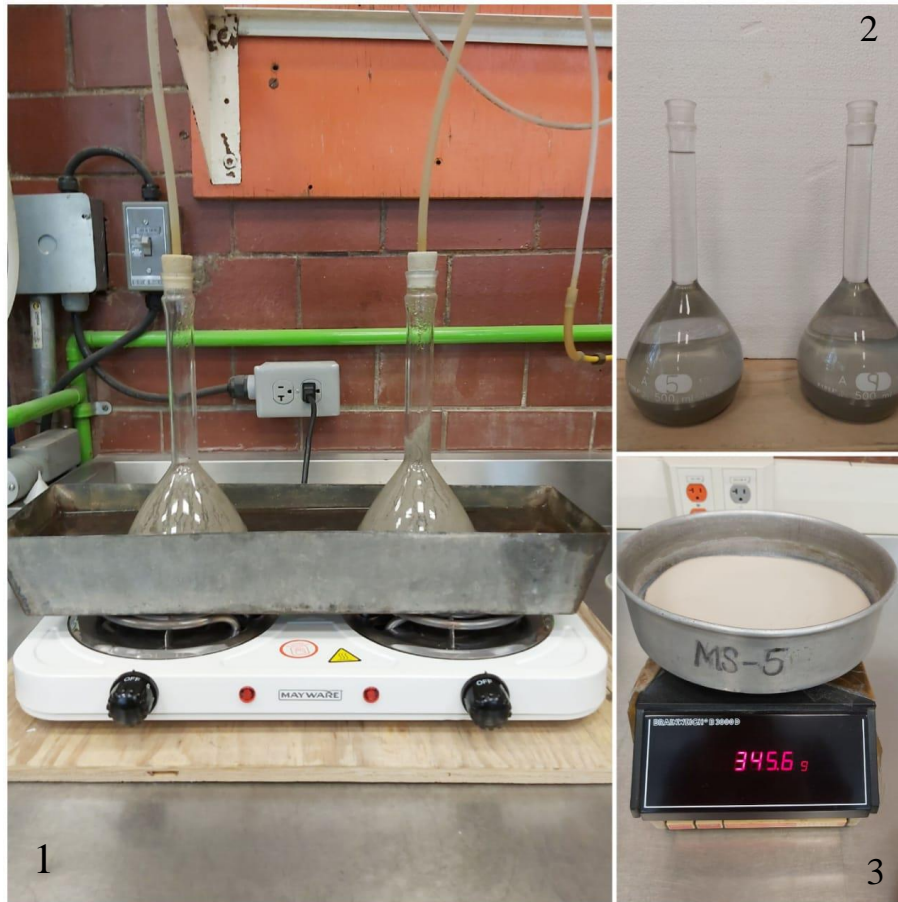
Figura 5.2. Fotografías de la metodología para la densidad de sólidos.
