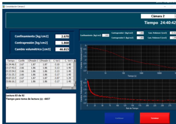
Figura 4.20. Prueba de consolidación.
