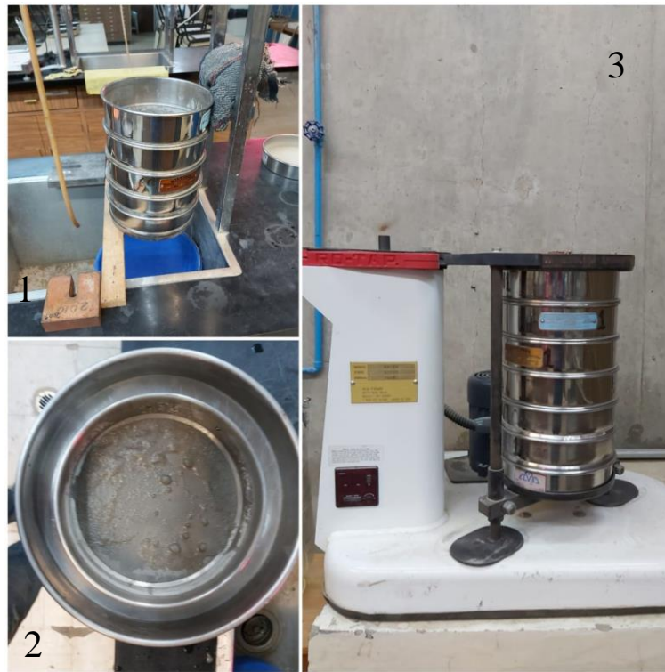
Figura 5.4 Fotografía del procedimiento de granulometría por vía húmeda.
