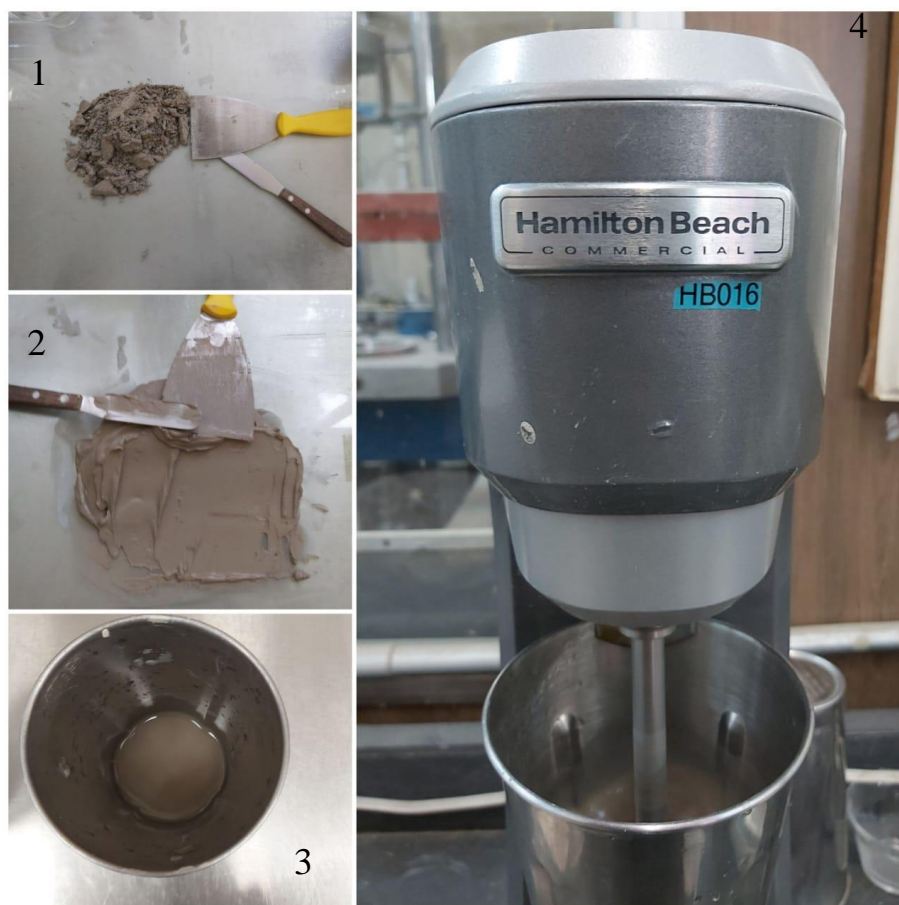
Figura 5.1. Fotografía de la metodología para la densidad de sólidos.
