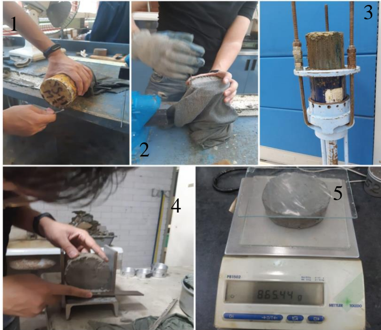
Figura 5.6. Fotografías del procedimiento de extracción para una probeta inalterada.
