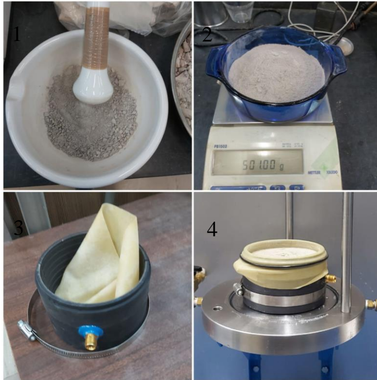
Figura 5.7. Fotografías del procedimiento de reconstitución de probetas.
