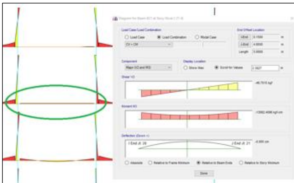
Imagen 5.21.- Diagrama de momento de elemento T-2.
