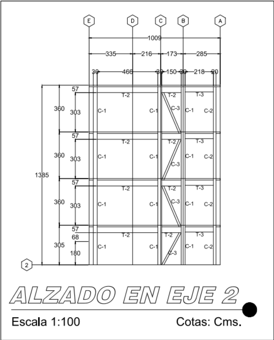
Imagen 5.23.- Plano del modelo actual, vista sobre el eje dos.
