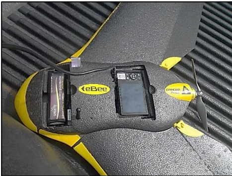
Figura 15. Cuerpo central eBee, batería y cámara
