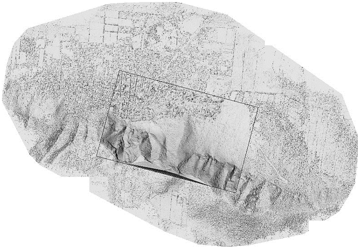
Figura 7.1 Modelos digitales de sombras generados a partir de MDE de 2 m (recuadro central) y MDS de 0.1264 m de resolución espacial. Fecha de vuelo UAV y escaneo TLS: Noviembre, 2017.
