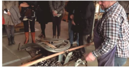
1.2 Colocar las piezas sobre el molde y sujetarlas con una prensa a la guía metálica.
