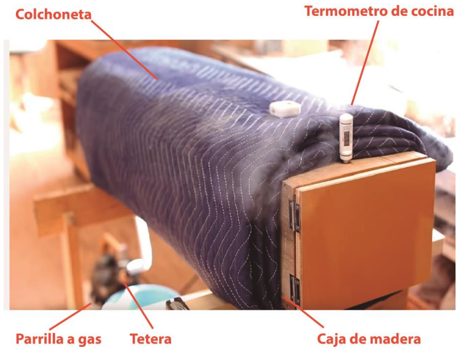
Ilustración 10. Doblado de madera con caja de vapor. Ishitani furniture. (2019), http://www.youtube.com
