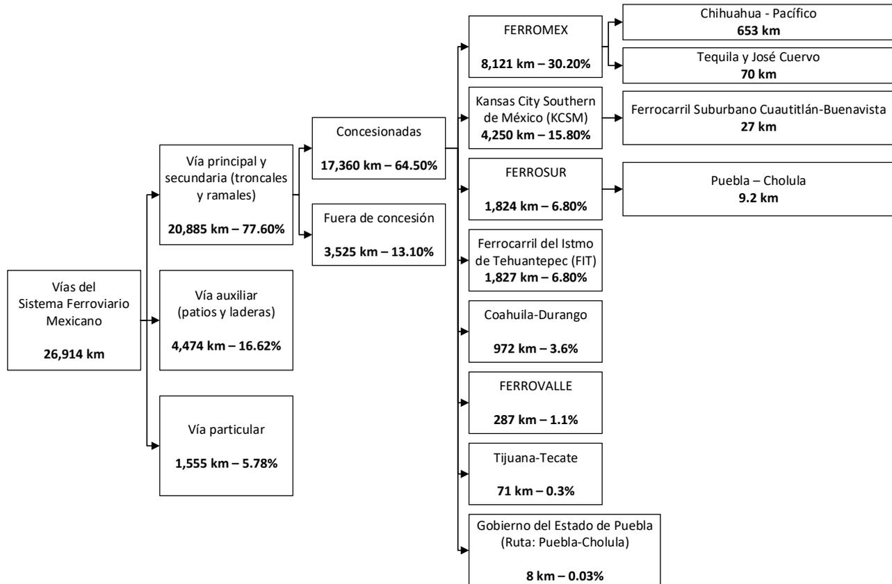
Figura 2. Composición y esquema concesionario del Sistema Ferroviario Mexicano al año 2019.
