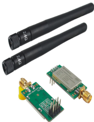
Ilustracion 3.1.4. Módulo de Comunicación para ASTEC (imagen original obtenida de: https://www.amazon.com/MakerFocus-nRF24L01P-Transmission-Interface-Anti-Interference .)
