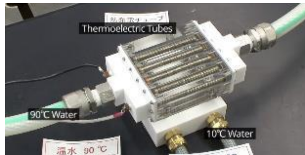
Figura 40. Tubos termoeléctricos. Panasonic.
