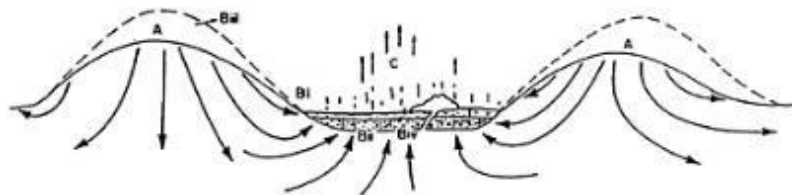
Figura 14. Sección transversal de la cuenca del Valle de México. UNAM.
