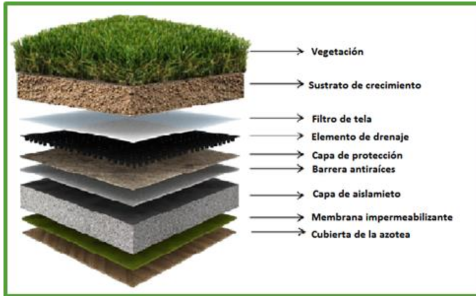
Figura 1.13. Esquema de diferentes componentes de techo verde. Modificado de Vijayaraghavan K. (2015)
