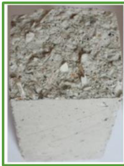
Figura 2.7. Sección de ruptura de especímenes rotos (ensayados). Modificado de Aciu C., et. al., 2018.
