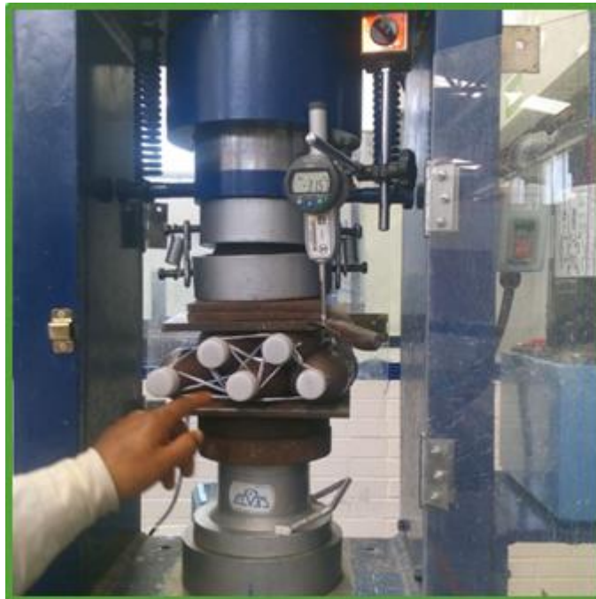
Figura 3.7. Ensayo de compresión simple en botellas de PET (Peñafiel).
