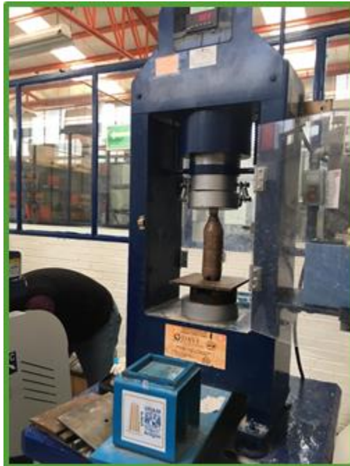
Figura 3.11. Ensayo de compresión simple en botella de PET.
