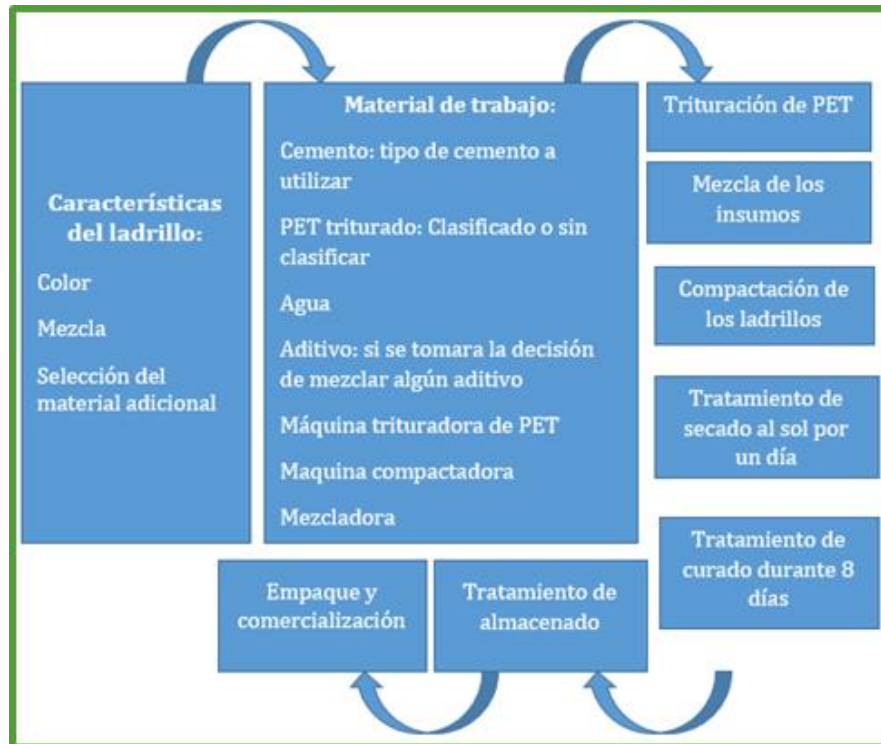
Figura 2.6. Diseño esquemático del proceso de fabricación del ladrillo a base de PET.
