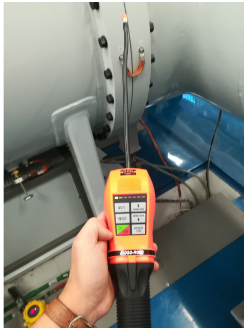
Figura 4.24: Uso del detector de SF 6 DILO 3-033-R002.
