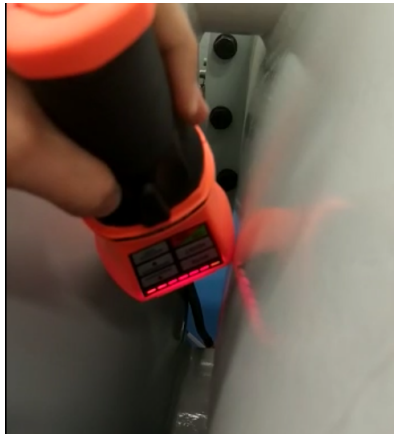
Figura 4.25: Detección de fuga en un atravesador del acelerador.
