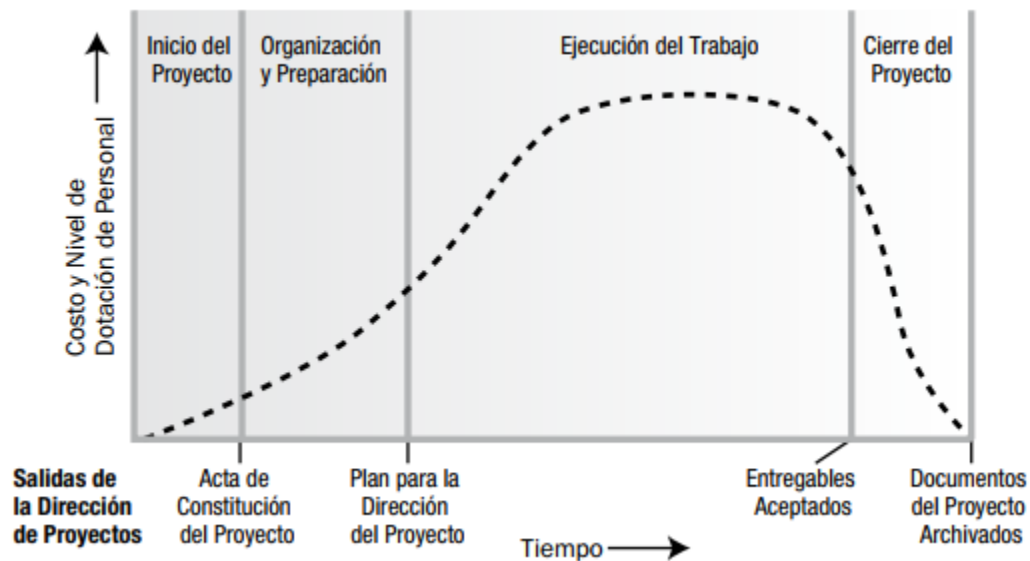
Ilustración 7. Curva típica de Costo y Dotación de personal en un proyecto. Fuente PMBOK, 2013.
