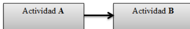
Diagrama 5. Relación Fin a Inicio del Método de Diagramación por Precedencia, PDM. Fuente: elaboración propia, Word 2010.
