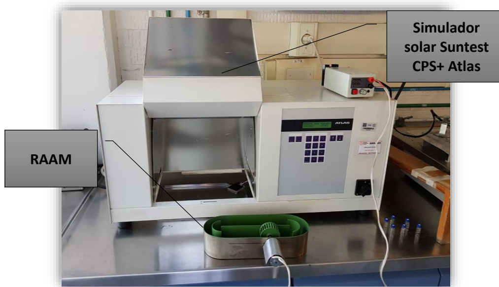
Figura 2.2. Sistema experimental empleado en todos los experimentos
