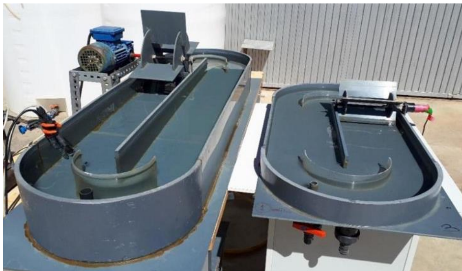
Figura 1.3 Esquema de un reactor RAAM o “Raceway”, (CIESOL, 2019)
