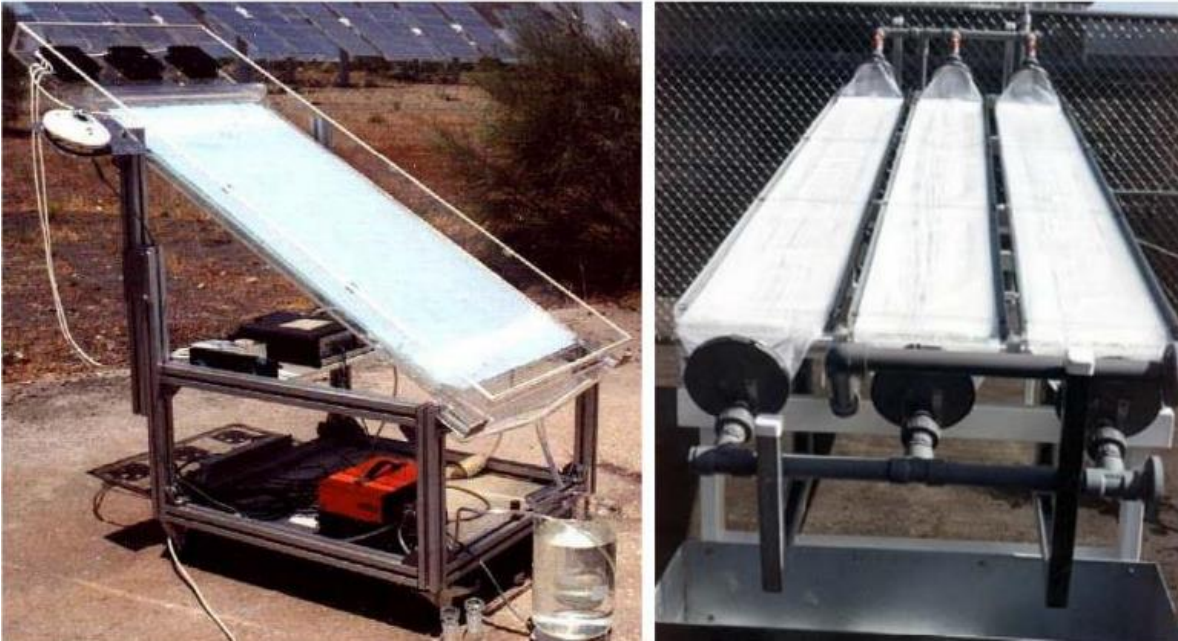
Reactores solares sin concentración solar; Captador solar estático de placa inclinada, PSA, Almería (Izquierda); Prototipo de captador tubular, NREL, USA (Derecha) (Blanco, 2003)
