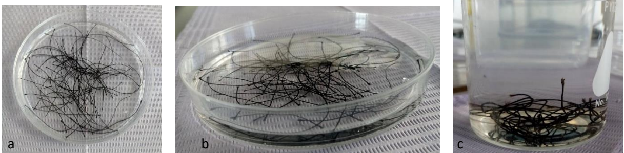
Figura 7. Secuencia del proceso de corte de los fragmentos de sutura(a), desgomado con NaOH(b) y lavado en agua destilada(c).
