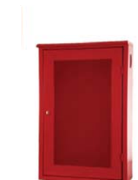
GABINETE CONTRA INCENDIOS EQUIPO CONTRA INCENDIO MARCA EXTIN-FLAM, GABINETE METALICADO PARA ALMECENAR MANGUERAS DE HIDRANTE, FABRICADO DE LAMINA DE ACERO AL CARBON, CALIBRE 22, CGAPA CROMADA Y 2 LLAVES, EMPOTRADO CON UNA ALTURA DE 75 CM ANCHO DE 50 CM Y FONDO DE 21 CM PESO 9.9 KG
