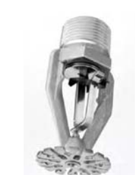
ROCIADOR ROCIADOR COLGANTE DE SUPRESION TEMPRANA Y RESPUESTA RAPIDA, MARCA TYCO, MATERIAL DE ACERO INOXIDABLE, ACABADO DE LATON, COBERTURA DE 9.3 M2 COBERTURA MINIMA 5.8 M2
