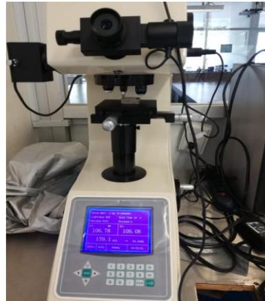
**Figura 3.7.** Microdurómetro NOVOTEST TC-MCV-1A.
