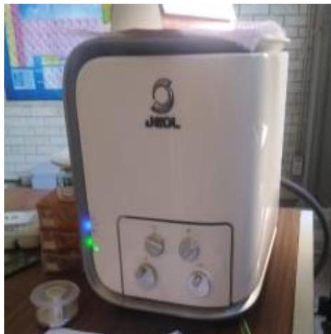
**Figura 3.6.** Microscopio electrónico de barrido JEOL NeoScope JCM-6000Plus.
