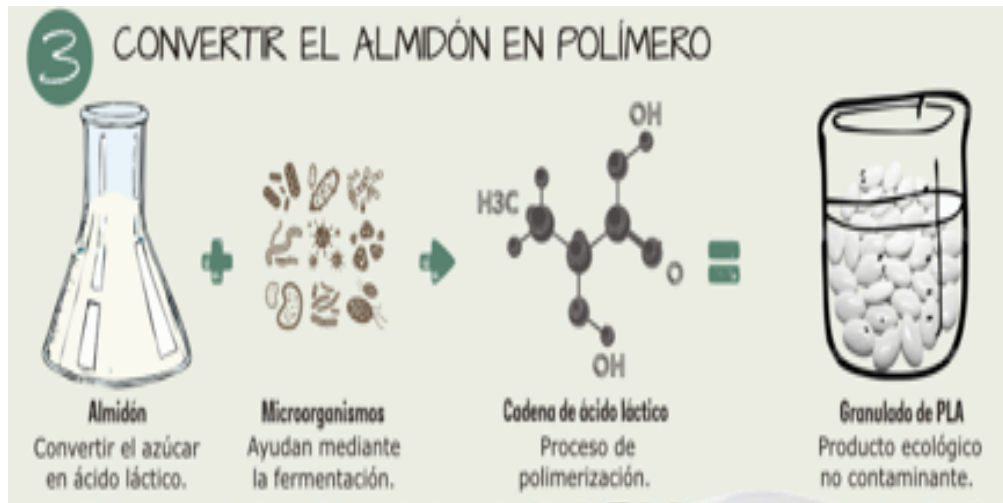
Figura 52. Proceso para convertir almidón en un polímero
