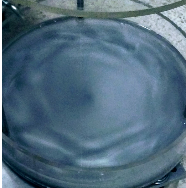
Figura 3.2: Visualización del flujo con kalliroscope para \Gamma = 3.55 , Re = 180 y S = -0.344 después de 5 minutos.
