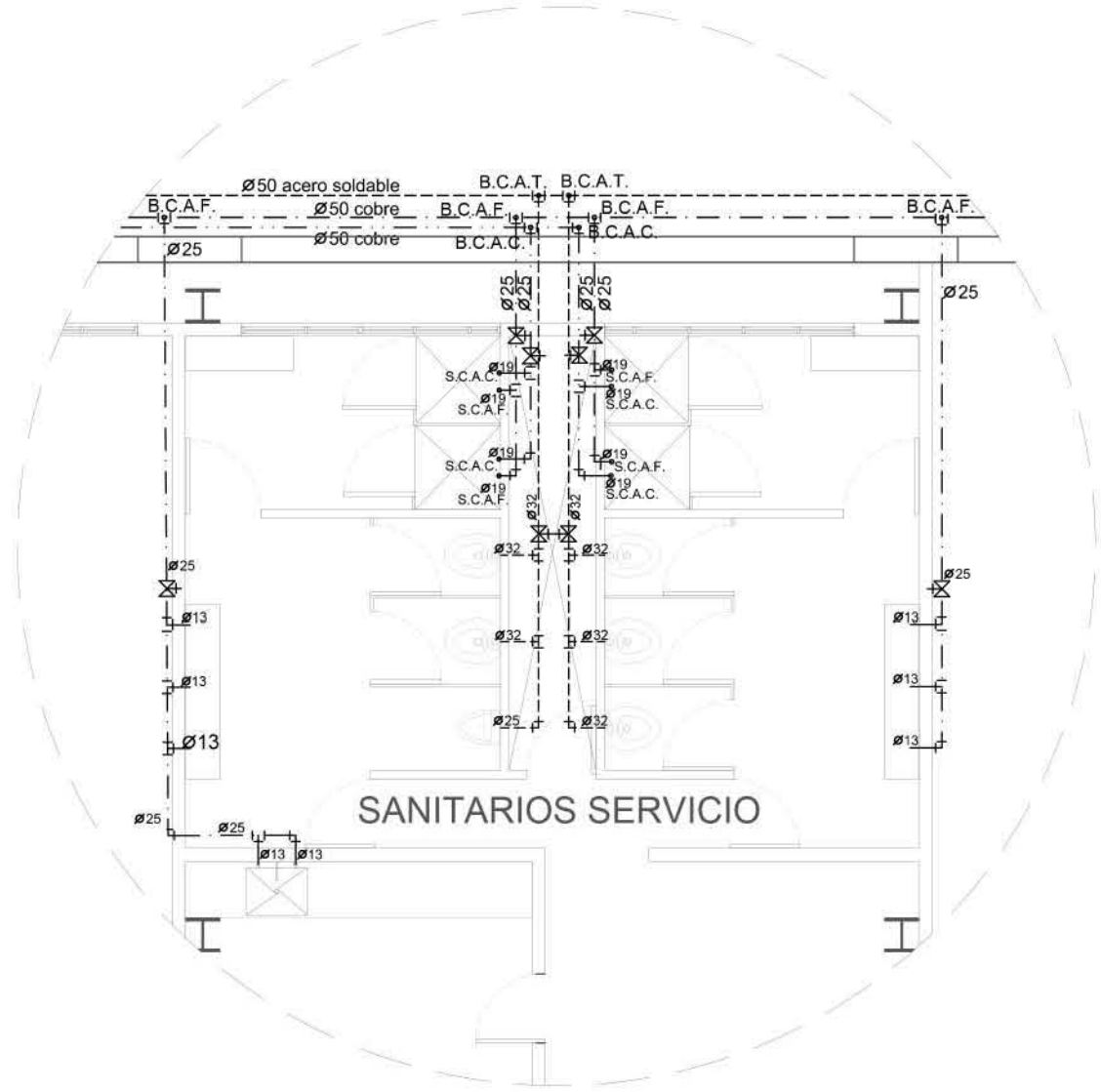
DETALLE DE NÚCLEO SANITARIO 01 (SERVICIO)
