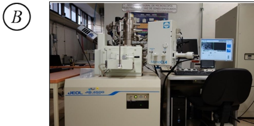
Figura Ap. I.3.1. (A) Esquema de la configuración de un microscopio de barrido convencional. (B) Fotografía del SEM JEOL JIB-4500, utilizado en esta tesis.
