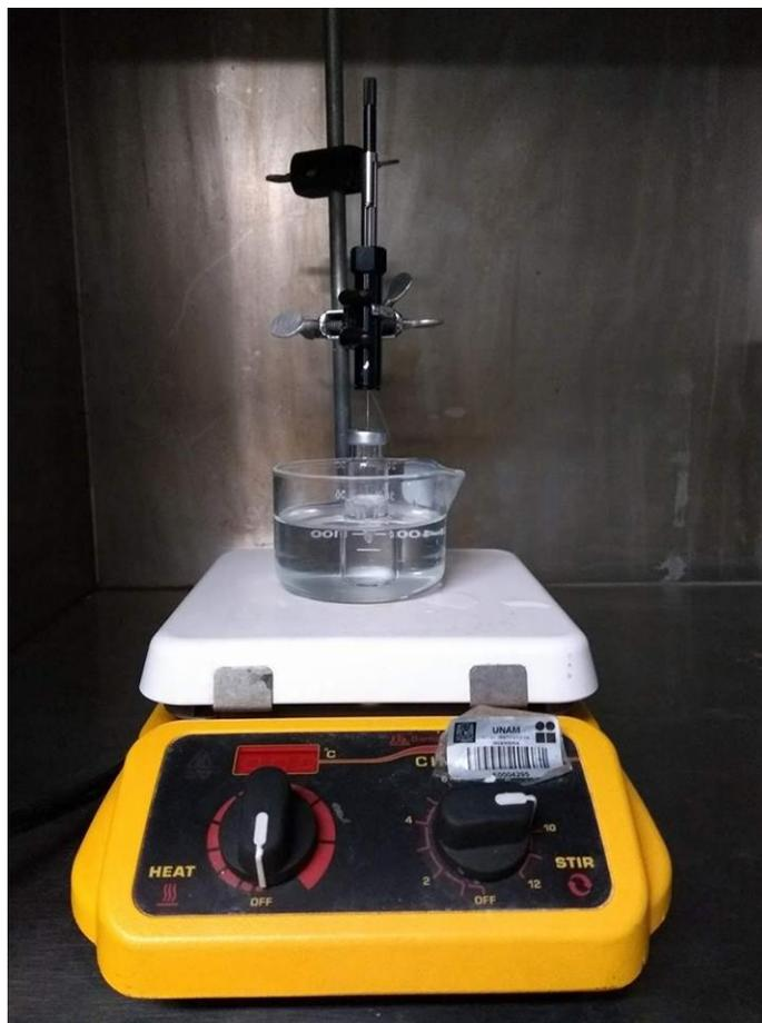
Figura 9. Sistema de extracción HS-SPME.
