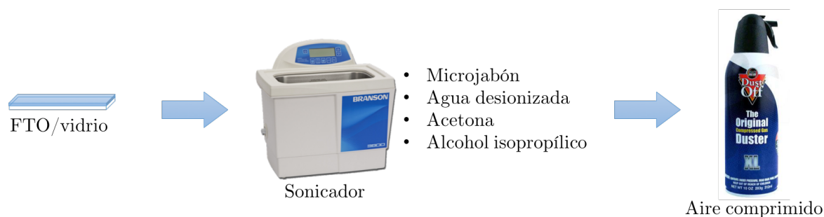
Figura 4.1: Proceso de limpieza de sustratos.
