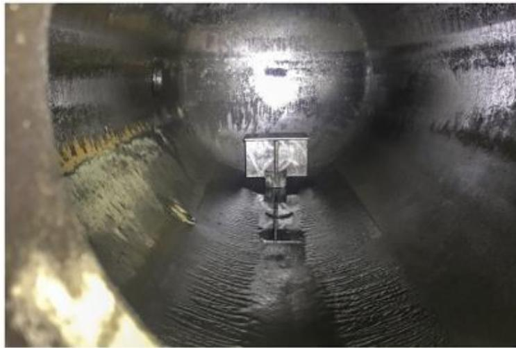
(b) Después de una operación de limpieza, se eliminó toda la arena; se observa que las marcas en las paredes del separador indican el nivel típico de la producción de los líquidos asociados.
