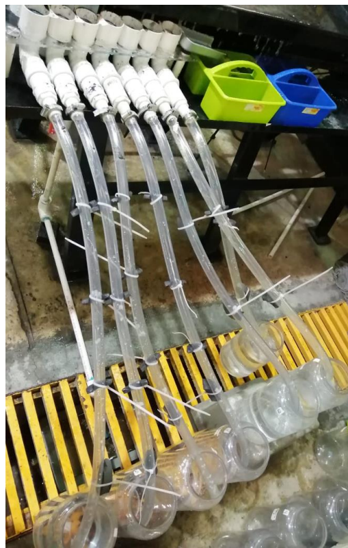
Figura 20. Dispositivo de separación magnética de baja intensidad con sistema de magnetos permanentes en ductos de plástico.
