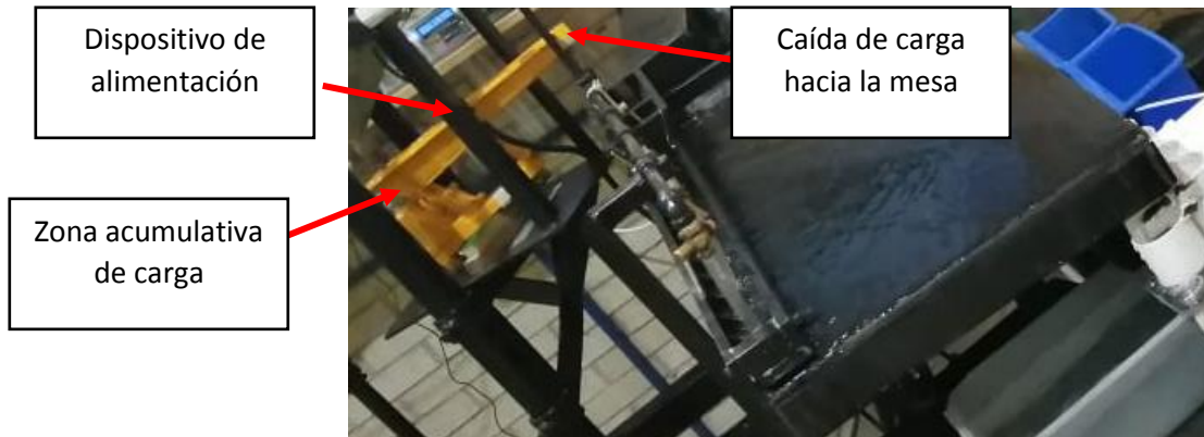
Figura 51. Alimentador de carga hacia Mesa Wilfley.
