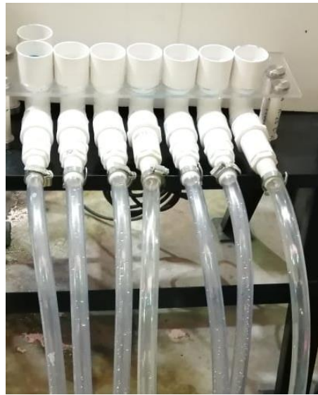
Figura 18. Dispositivo de separación magnética de baja intensidad. Ductos de plástico donde se lleva cabo la separación.
