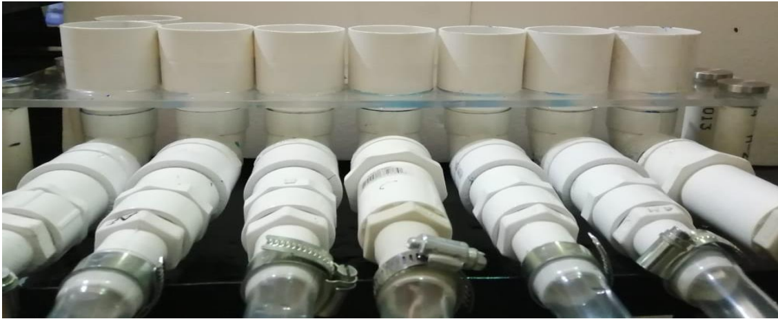
Figura 17. Dispositivo de separación magnética de baja intensidad. Campanas de captación de mineral y conexiones por donde el mineral es transportado.
