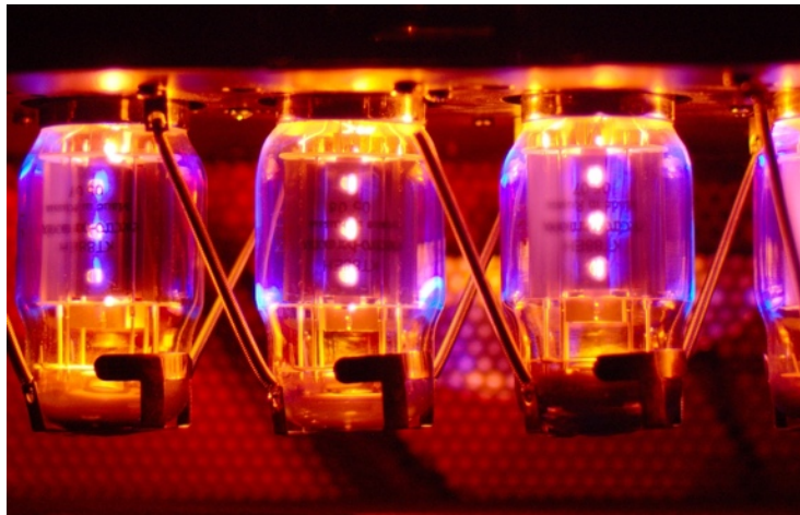
Ilustración 4. Tubos de vacío Electro Harmonix KT88 para la etapa de potencia de un amplificador
