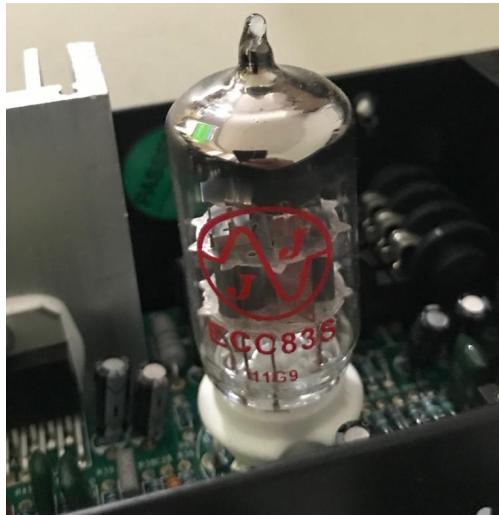
Ilustración 11. Bulbo de la compañía JJ modelo ECC83S en el circuito de preamplificación del amplificador Orange Micro Dark
