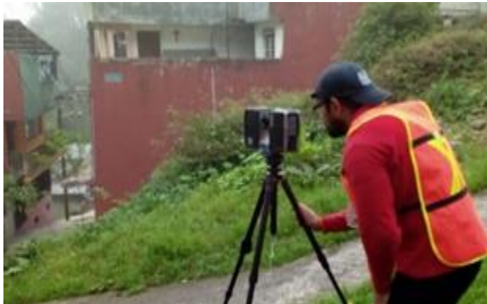
Figura 4.8 ilustración del equipo FARO FOCUS 3D , foto autoría propia (2018).
