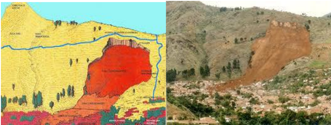
Figura 1.4 Plano descriptivo sobre el deslizamiento sobre el barrio de Villatina, tomado de Coupé et al. (2007.)
